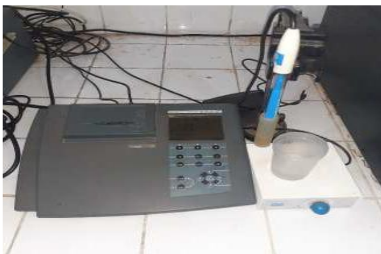
Figure 1 : Terminal INOLAP740 (pH-conductivité)
