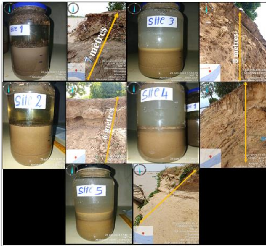
Planche Photographique 6 : Résultats granulométriques et morphologie des berges du site 1-5
